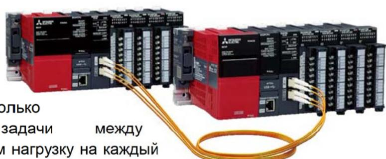
резервированных конфигураций позволяет создавать высоконадежные САУ с высоким уровнем готовности, что гарантирует полною работоспособность системы управления даже в случае единичного отказа, как оборудования, так и сетей обмена данными.
