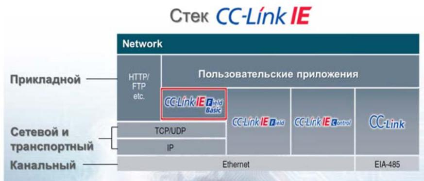
CC-Link – это целое семейство сетей, объединенное общими принципами организации обмена данными. На канальном уровне сети CC-Link могут строиться на протоколах EIA-485 и Ethernet. В последнем
